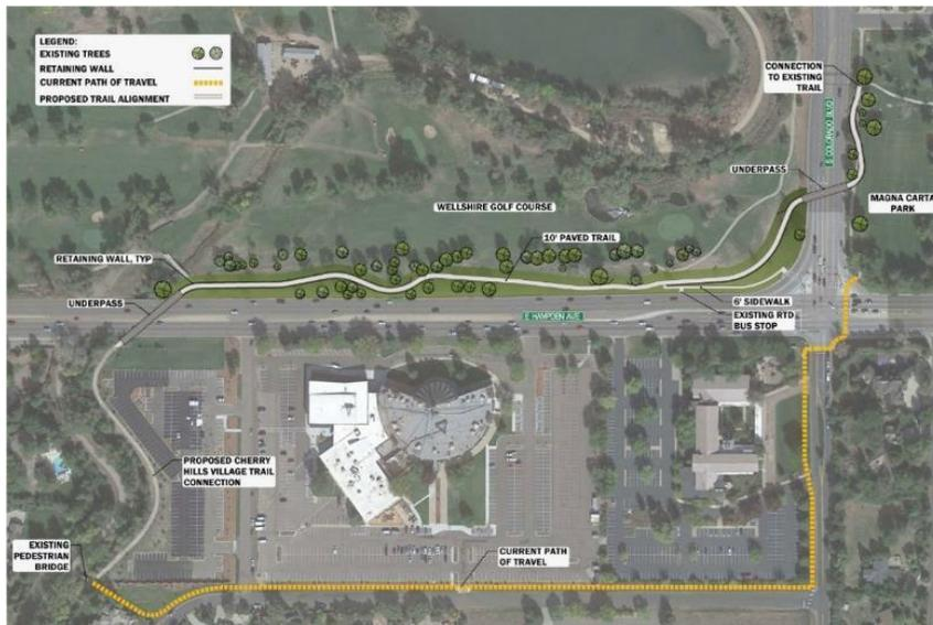
Esta sección de High Line Canal Trail, de aproximadamente media milla (800 m) de largo, está adyacente a la Avenida Hampden, en la intersección con Colorado Blvd. El camino pavimentado y el paso subterráneo proporcionarán una conexión segura a través de esta intersección muy usada por ciclistas y peatones. Esta área transporta tráfico vehicular pesado, con un promedio de más de 80.000 vehículos por día.
